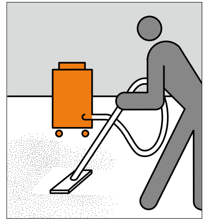
10 Staub entfernen durch Saugen.
